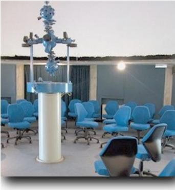
Il Planetario è un proiettore in grado di riprodurre su una cupola l'immagine della volta stellata visibile ad occhio nudo da ogni parte del mondo. Lo strumento, grazie ai suoi complicati sistemi meccanici, permette di riprodurre i principali moti celesti. Le stelle che si contano sulla cupola sono alcune migliaia e di fronte a questa insolita distesa di astri lo spettatore potrebbe pensare di trovarsi di fronte a un cielo
