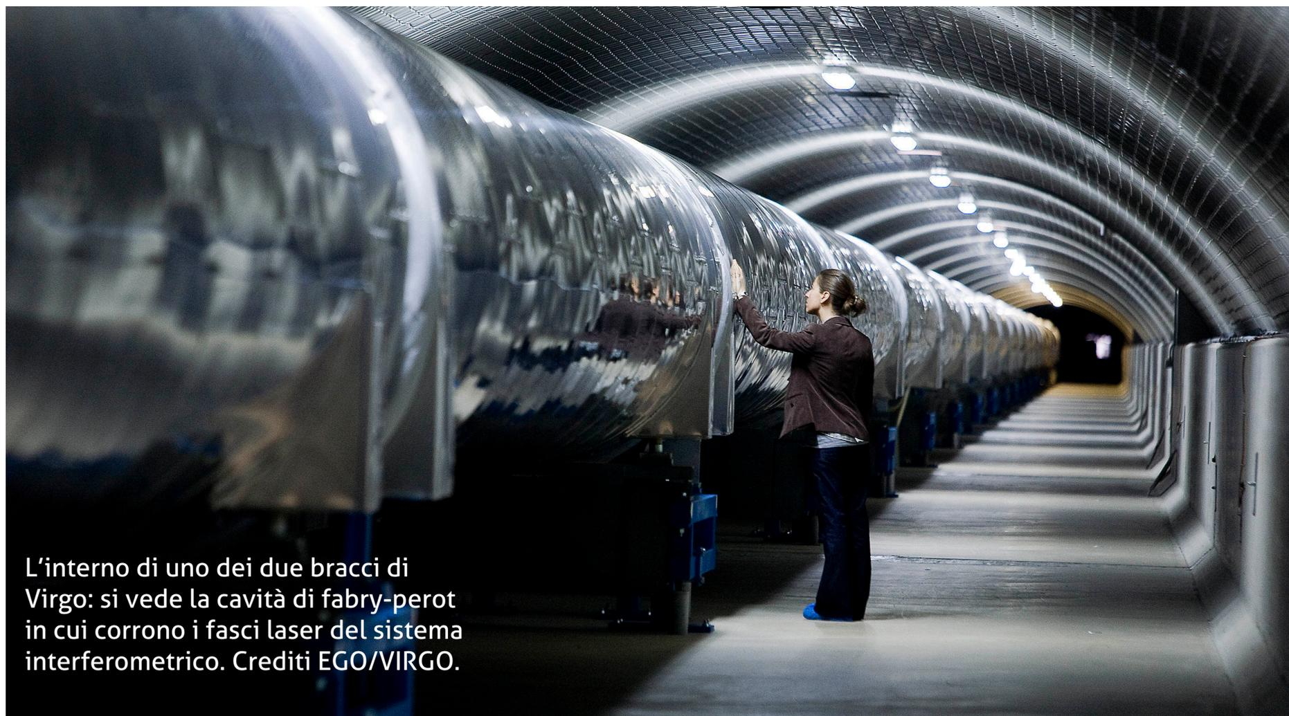
L'interno di uno dei due bracci di Virgo: si vede la cavità di fabry-perot in cui corrono i fasci laser del sistema interferometrico. Crediti EGO/VIRGO.
