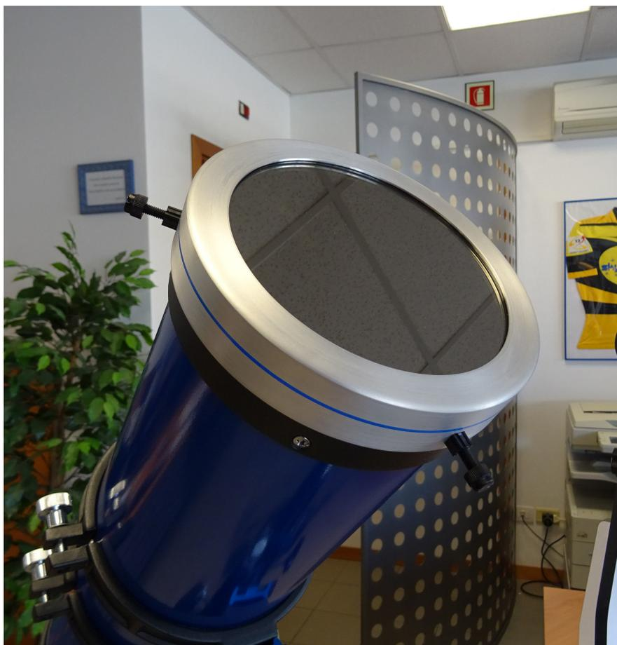
**Sopra.** Un esempio di filtro in vetro applicato su telescopio Newton da 130 mm
