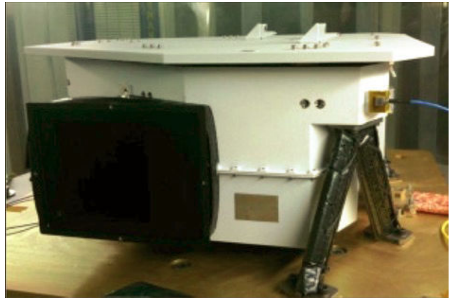
Sopra. Lo strumento JIRAM. E' montato su uno dei lati di Juno e punta nella stessa direzione di altri strumenti ottici come UVS e JunoCam. Crediti: NASA/JPL
