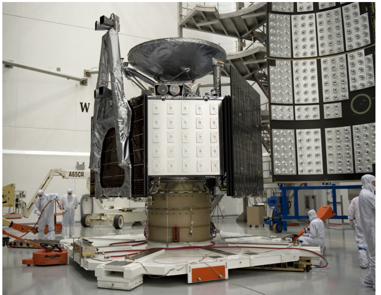
Sopra. Cinque delle sei antenne MWR di Juno sono posizionate su uno dei lati della sonda. La più grande delle sei antenne MWR occupa invece un intero lato. Crediti: NASA/JPL
