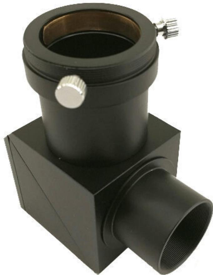
All'interno del diagonale è già montato un filtro ND3, lavorato con un trattamento interferenziale verde (picco tra i 510 e 550 nm) che rende molto più contrastati i dettagli della superficie del Sole. In dotazione c'è anche un filtro polarizzatore circolare che, avvitato all'oculare, permette di regolare in maniera molto precisa la luce solare che arriva all'occhio.
