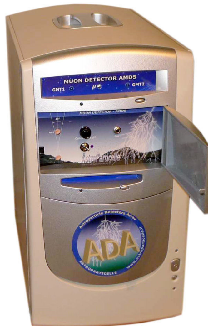
Sopra. Il rivelatore AMD5 (Astroparticle Muon Detector-5). Sotto. Figura (A) Illustrazione del metodo delle coincidenze (vedi testo), (B) Campo inquadrato dal rivelatore rispetto alla sezione dei GMT, AMD5 inquadra un angolo solido totale pari a circa 0.5 sr.
