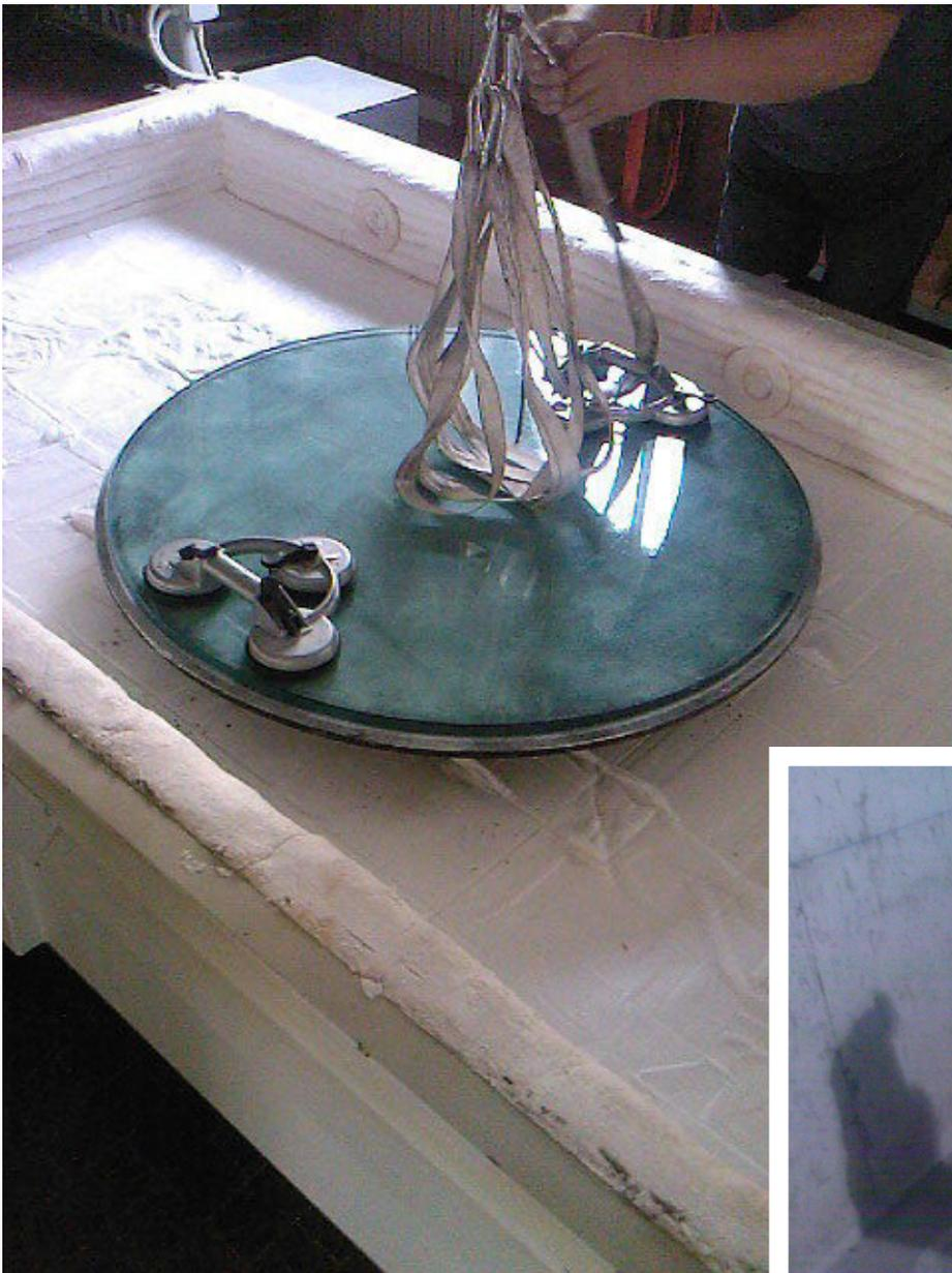
**A sinistra.** Il disco di vetro da un metro di diametro nel forno della vetreria al termine della piegatura a caldo.
