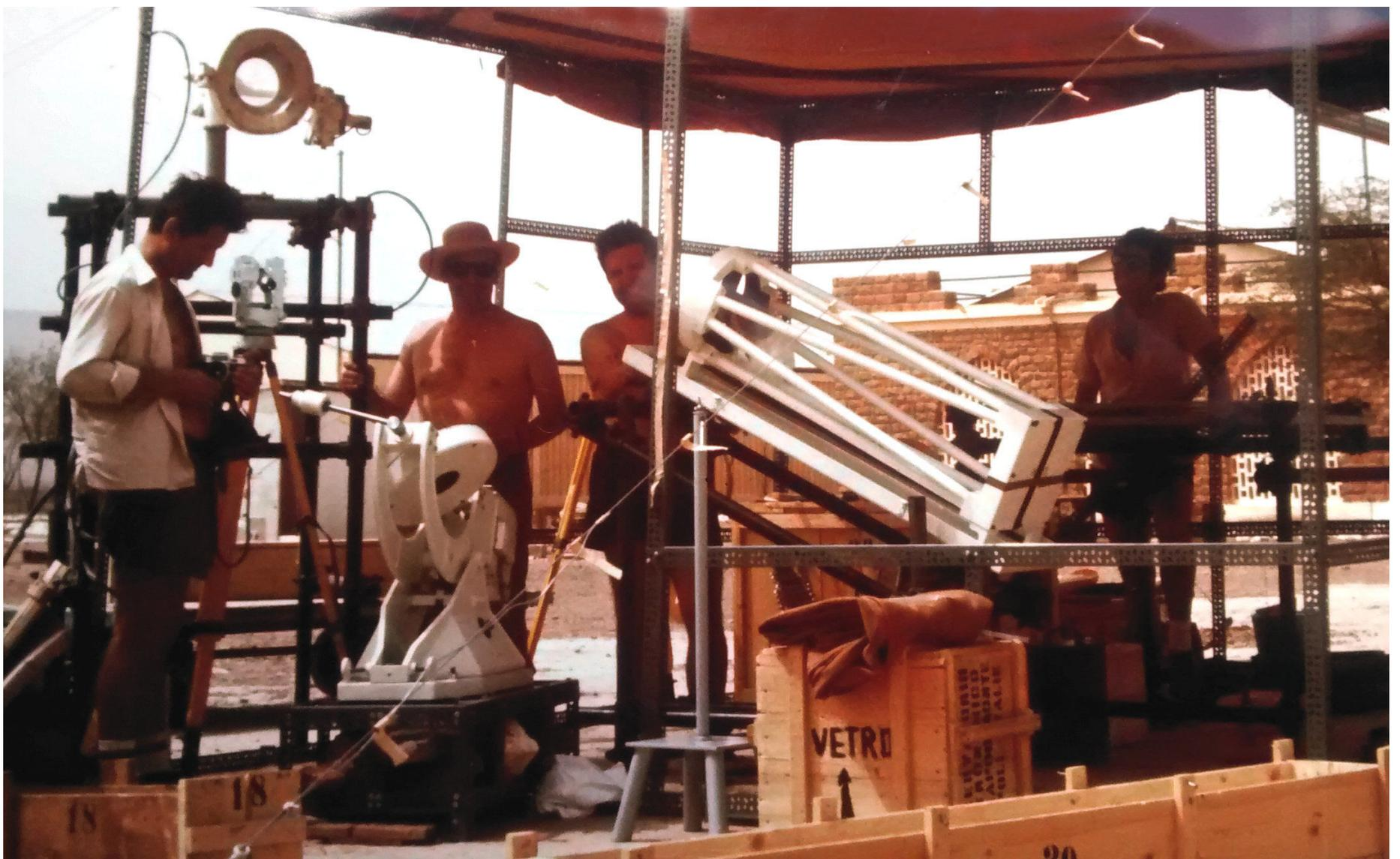
**Sopra.** Atar (Mauritania). Un'immagine del campo-base con la strumentazione per l'osservazione dell'eclisse di Sole del 30 giugno 1973. Parte dello strumento: a sinistra, il celostata a due specchi e nel centro il telescopio Gregory; lo spettrografo si trova dietro le persone.
