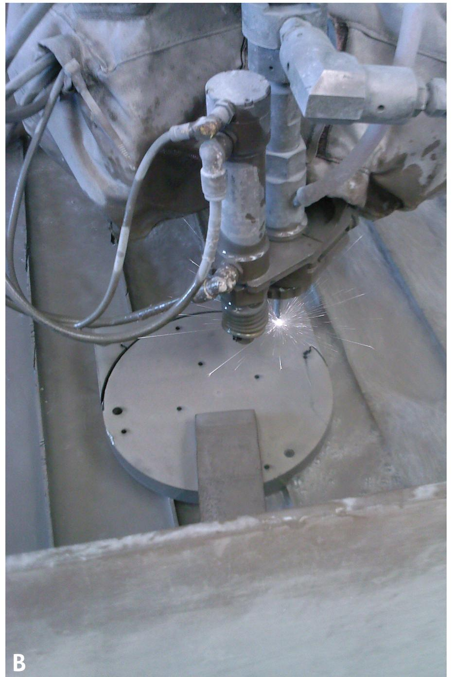
**Sopra.** Parti meccaniche in fase di lavorazione: **nella figura A** il legno multistrato della struttura del telescopio; **nella figura B** il taglio ad acqua; **nella figura C** la tornitura dell'utensile in ferro da un metro di diametro, per la lavorazione dello specchio.
