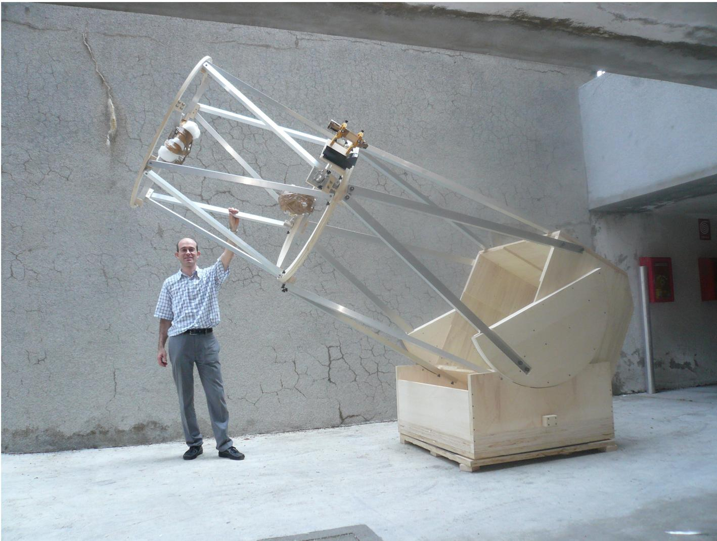
**A sinistra.** Struttura meccanica del telescopio da un metro, ancora grezza ma completa e funzionante.
