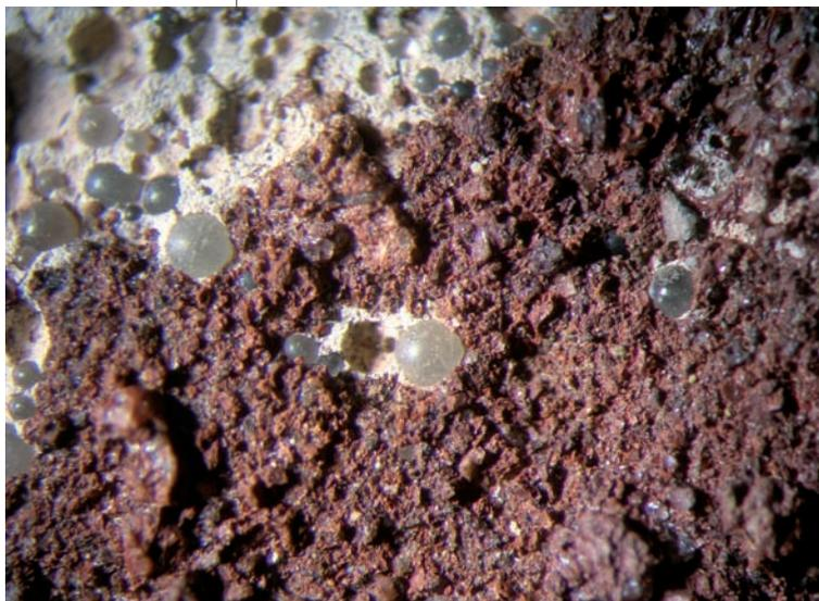
**S**opra, un primo piano di varie sferule vetrose su breccia rossa con intrusioni di carbonato di calcio. Le dimensioni delle sferule sono prossime a 1 mm.
