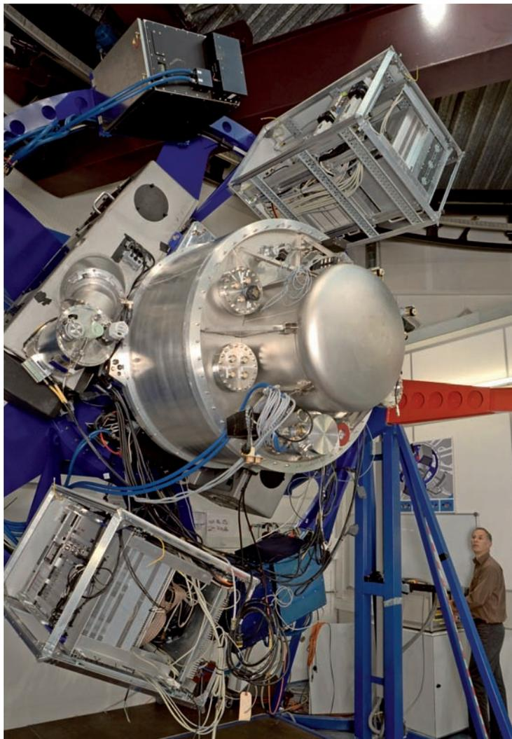
**E**cco un primo piano dell'X-shooter spectrograph, il primo degli strumenti di seconda generazione in dotazione al Very Large Telescope. Questo imponente e potentissimo strumento è stato impiegato nell'acquisizione degli spettri di CFBDSIR2149. [ESO]
