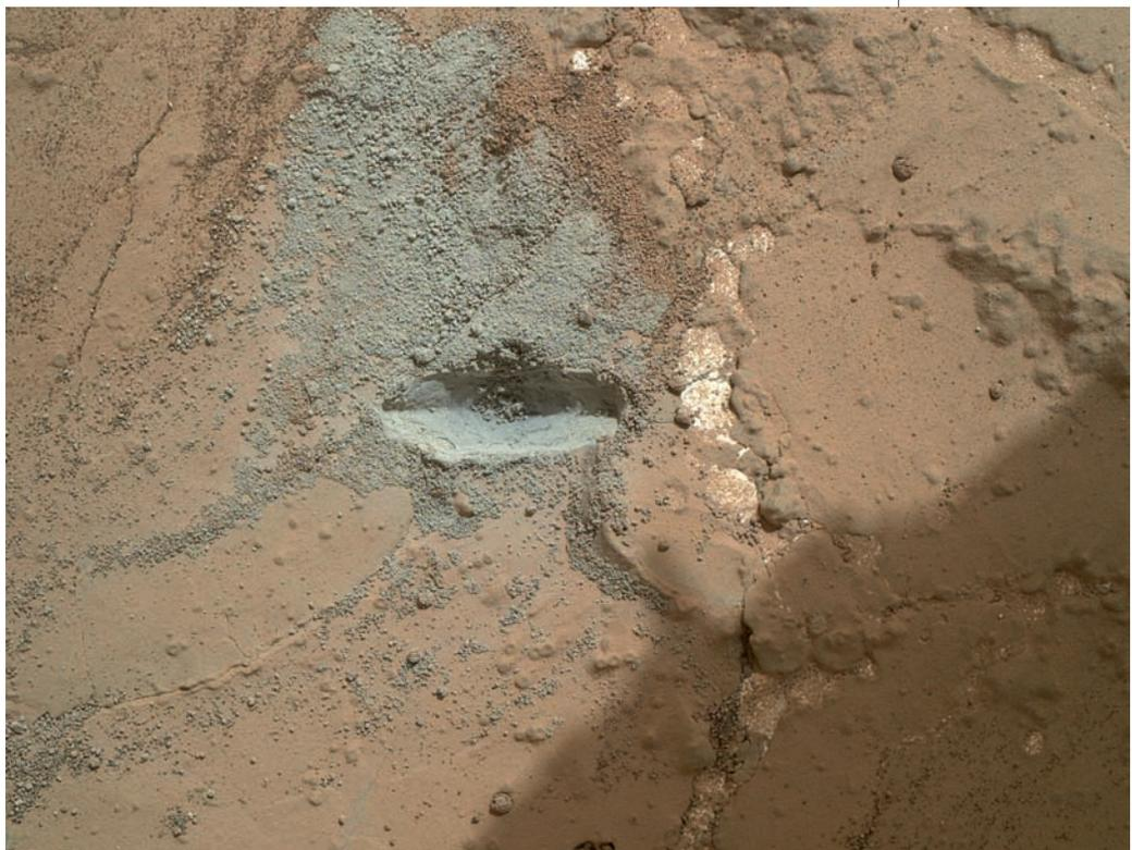
**La fase preparatoria alla trapanatura della roccia marziana ha previsto anche il solo uso della percussione, senza rotazione della punta. Ecco il risultato di quell'attività su un terreno soffice, ripreso con la Mars Hand Lens Imager (MAHLI) camera. [NASA/JPL-Caltech/MSSS]**
