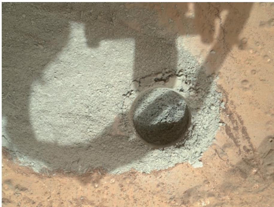
**Il buco visibile qui a sinistra, largo 1,6 cm, rappresenta la prova generale della perforazione della roccia John Klein. L'obiettivo non era andare in profondità ma generare abbastanza polvere da poter esaminare visualmente la sua consistenza ed eventuale umidità. [NASA JPL-Caltech/MSSS]**
