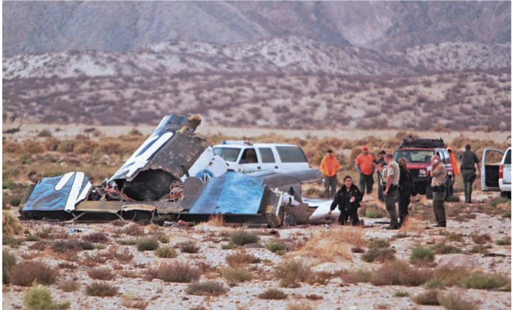
quasi 200 km a nord di Los Angeles) è apparso evidente che il combustibile non poteva essere la causa, non essendo esploso né il motore né il serbatoio.
