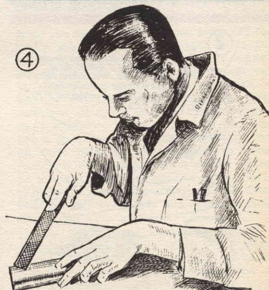
LA DUREZZA DELLA SUPERFICIE POTRA' ESSERE PROVATA CON UNA LIMA DI ACCIAIO RAPIDO
