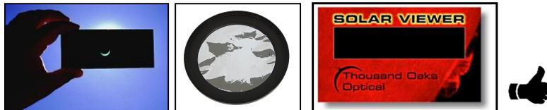
Il Sole può essere osservato al telescopio utilizzando esclusivamente filtri o dispositivi progettati per questo scopo. Si tratta di filtri sui quali viene depositato sopra a una superficie di supporto (vetro o film plastico) un sottilissimo strato di alluminio, di cromo o di argento. Questi filtri, oltre alla luce visibile, attenuano anche i raggi infrarossi e ultravioletti.
